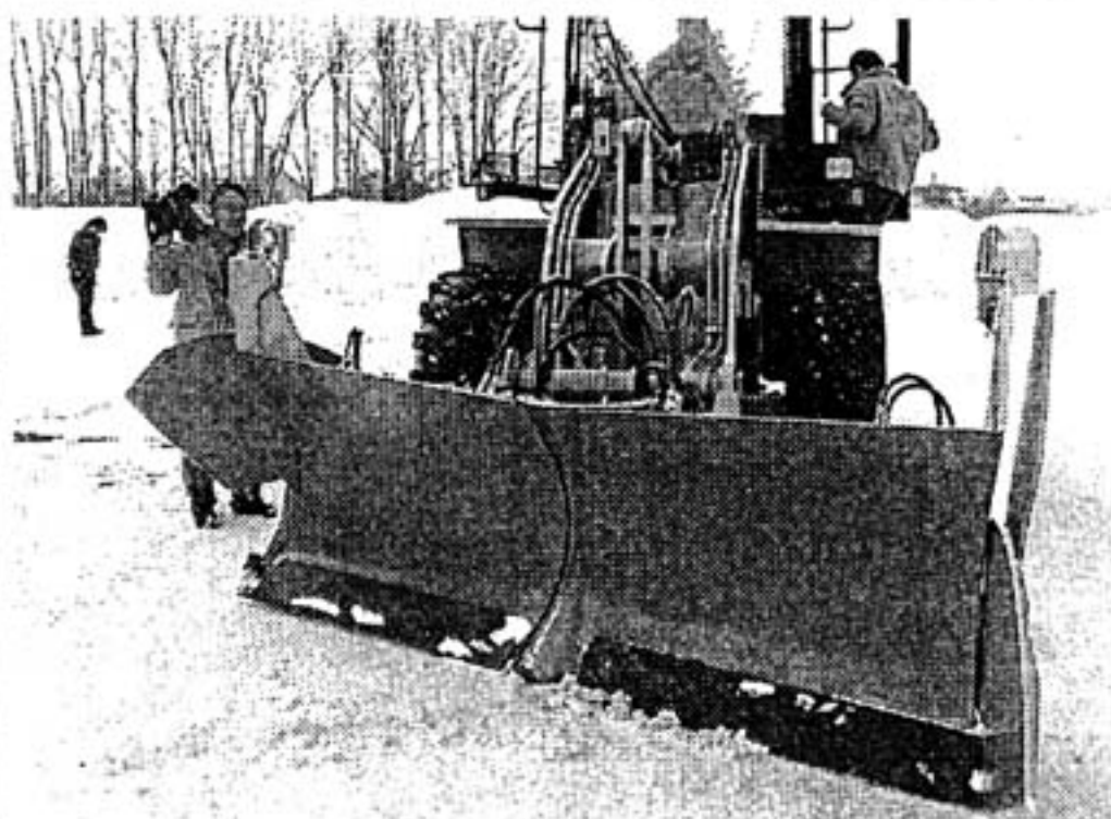
実証実験に用いるシャッター付きマルチブレードの除雪機
